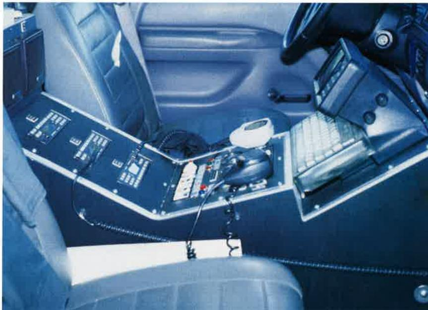
*Die Kommunikationskonsole in einer Ambulance mit drei Funkgeräten, einem Außenlautsprecher und dem MODAT.*
