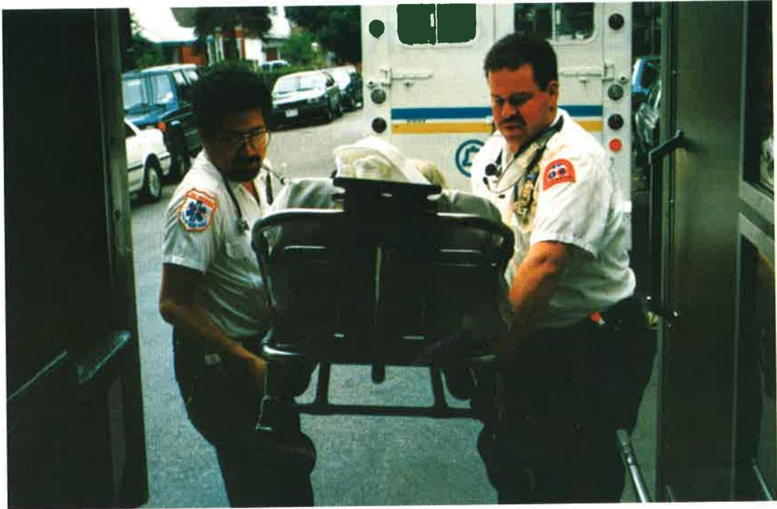
*Die Tragen können nicht in die Ambulance geschoben werden, sondern müssen von den Mitarbeitern hineingehoben werden, was zu hohen Belastungen der Wirbelsäule führt.*
