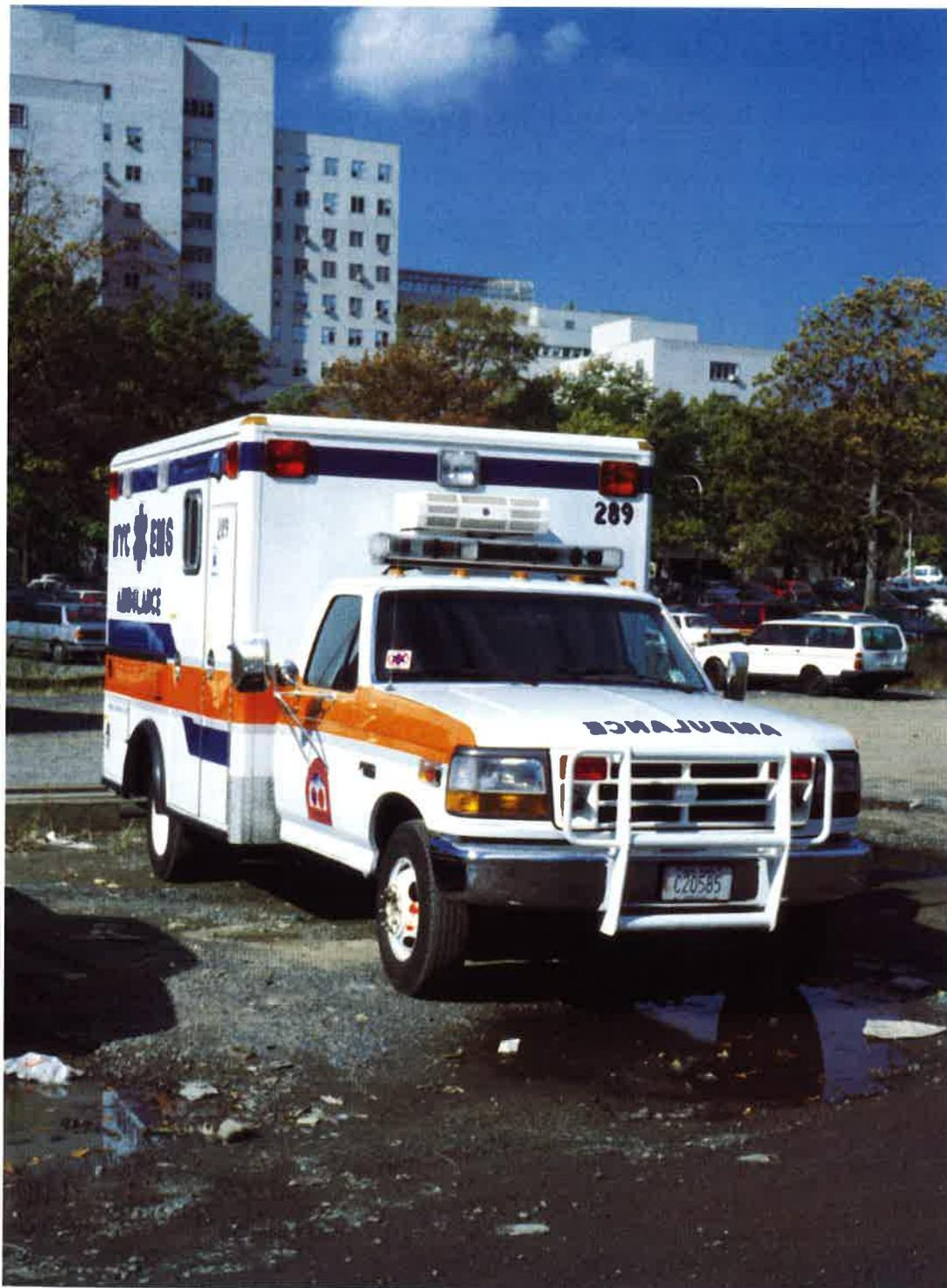
*Die neueren Ambulances verfügen über ein Rammgitter, das bei Auffahrunfällen den Zusammenstoß und die daraus resultierenden Schäden mildern soll.*
