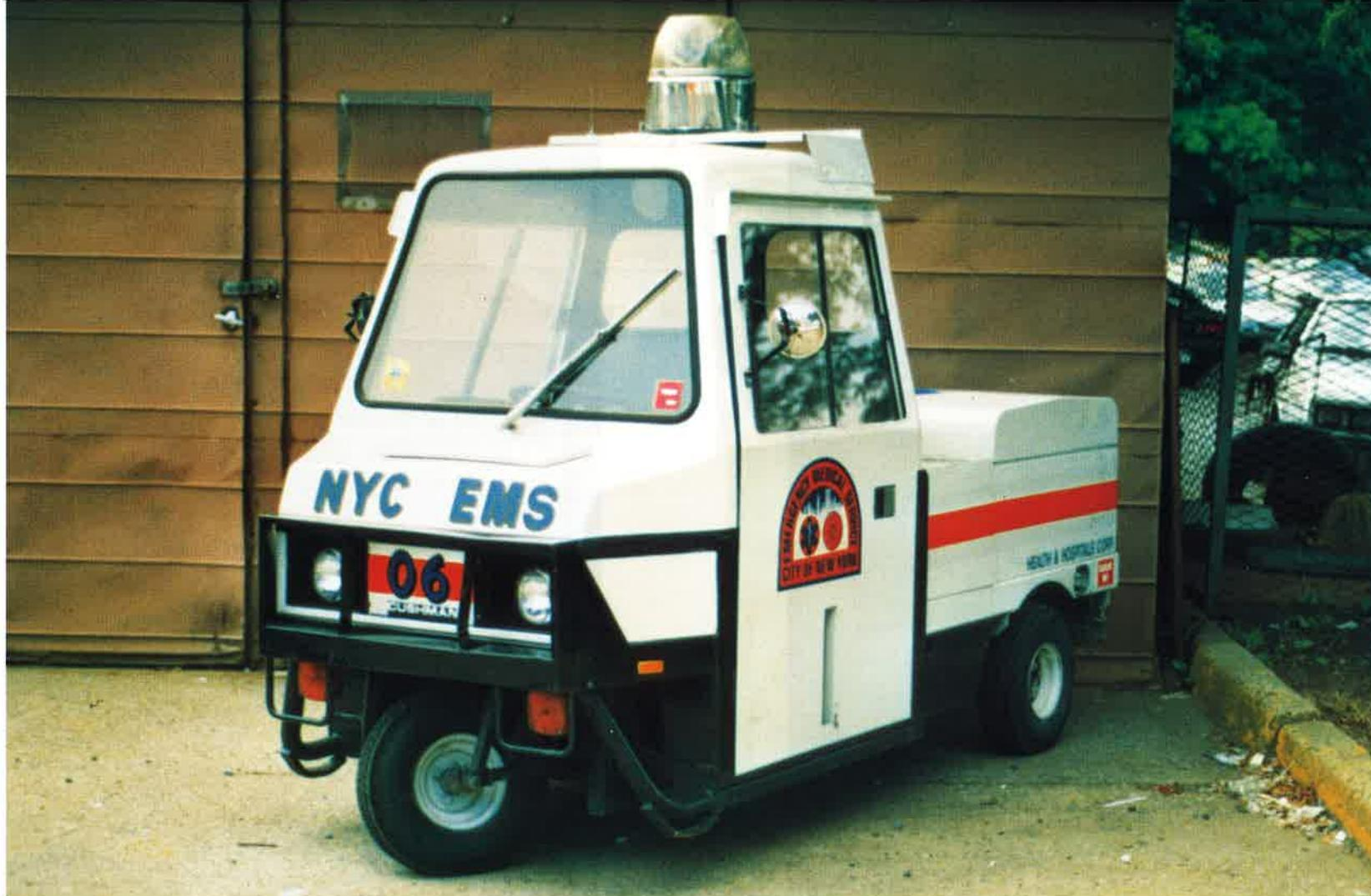
*Ein Sonderfahrzeug für Großveranstaltungen, zum Beispiel Paraden oder Konzerte. Besetzt werden diese bis zu 60 km/h schnellen Dreiräder mit einem EMS-Mitarbeiter. In der Heckbox befindet sich eine komplette Notfallausrüstung.*
